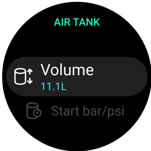
潛水前輸入使用的氣瓶容積及起始殘壓、潛水後儲存日誌前輸入結束殘壓，將可於日誌中檢視水面耗氣量(SAC Rate)
